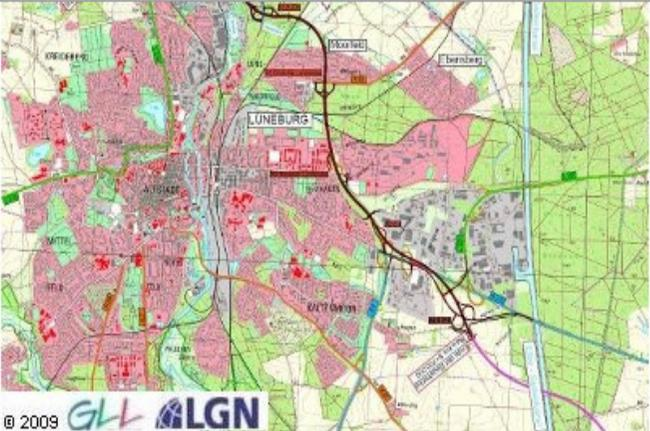
Die linienbestimmte Trasse der A 39 im Abschnitt 1 beginnt an der Anschlussstelle Lüneburg-Nord der Ostumgehung Lüneburg und verläuft ca. 5,6 km auf der Trasse der vorhandenen B 4. Nördlich der vorhandenen Verknüpfung der Ostumgehung mit der B 216 verschwenkt die A 39 Richtung Osten, verläuft ein kurzes Stück parallel zur B 216 und quert diese im Bereich des Gewerbegebietes Neu Hagen. Der erste Abschnitt endet östlich der Verknüpfung mit der B 216 und der L 221.
