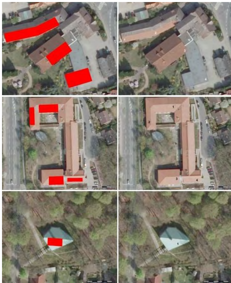
Abbildung 26 - Beispiel: Auswahl und Markierung geeigneter Dachflächen Quelle: Hansestadt und Landkreis Lüneburg, 2011
