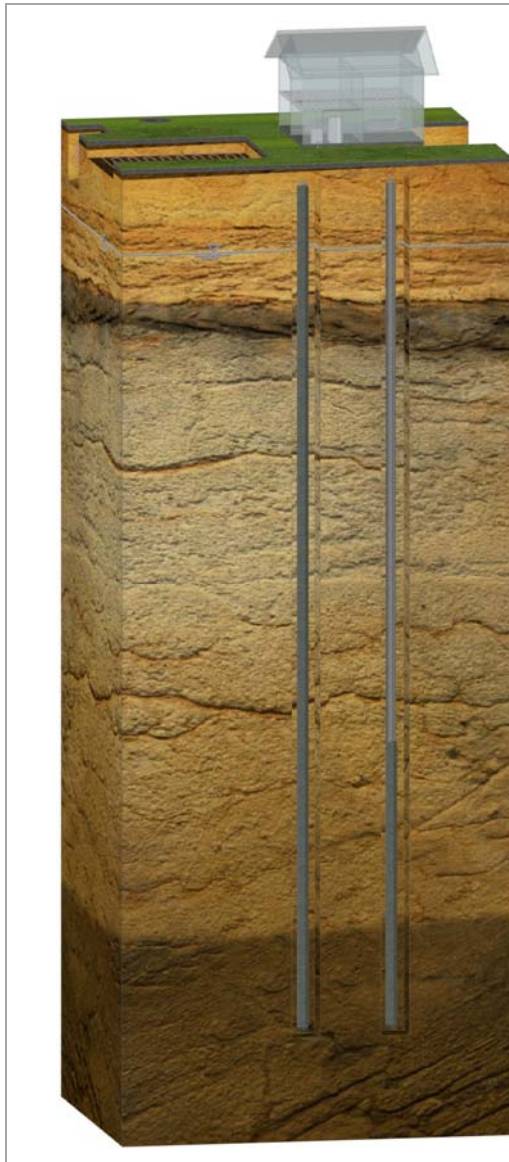
Abb. 2: Systemhaus mit Erdwärmesonde.
